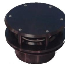
La série DV intègre un principe nouveau autorisant de très hauts débits en comparaison des soupapes conventionnelles de dimensions comparables. Le temps de réaction est de moins de 0,2 secondes. Les DV3-05 ont une pression différentielle d'ouverture de 35 millibar. Le débit est de 11,3 m<sup>3</sup>/minute à 85 millibar. La soupape est étanche en cas de dépression jusqu'à 350 millibar.
